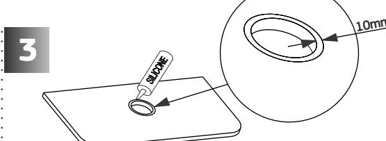
Com o tampo limpo, aplicar adesivo de silicone (não incluso) em forma de cordão, internamente à marca do contorno.
