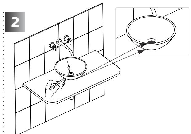
Marcar no tampo o centro da saída d'água da cuba e o contorno de sua base. Em seguida posicionar o **gabarito** ( $\varnothing 120\text{mm}$ ) sobre a marcação existente, centralizá-lo e cortar o tampo.
