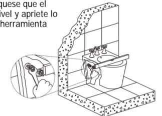
6 Dimensiones del tubo del sifón con 200 mm a partir de la pared. Arme el anillo de vedamiento en el codo de 40 mm. Em seguida arme el sifón
